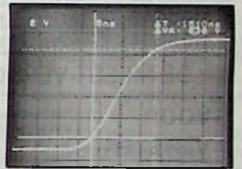
Afb. 16 Praktijkvoorbeeld van het meten van de stijgtijd van de voorflank van een puls.
