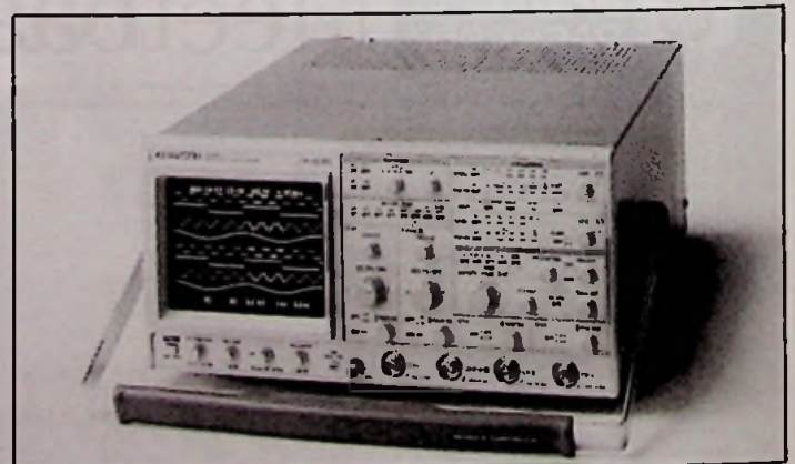
Afb. 6 Bij deze Kenwood heeft men de belangrijke instellingen van gevoeligheid en afbuig-snelheid nog wel met draaischakelaars uitgevoerd.
